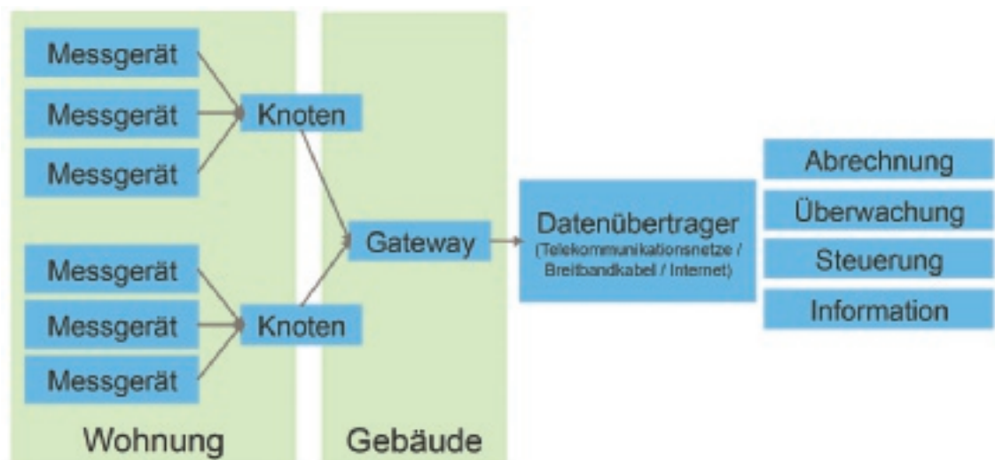
Abb. 71: Prinzip der Fernauslese 69
