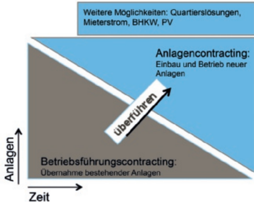
Abb. 56: Übergang Anlagen von der Betriebsführung in das Anlagencontracting
