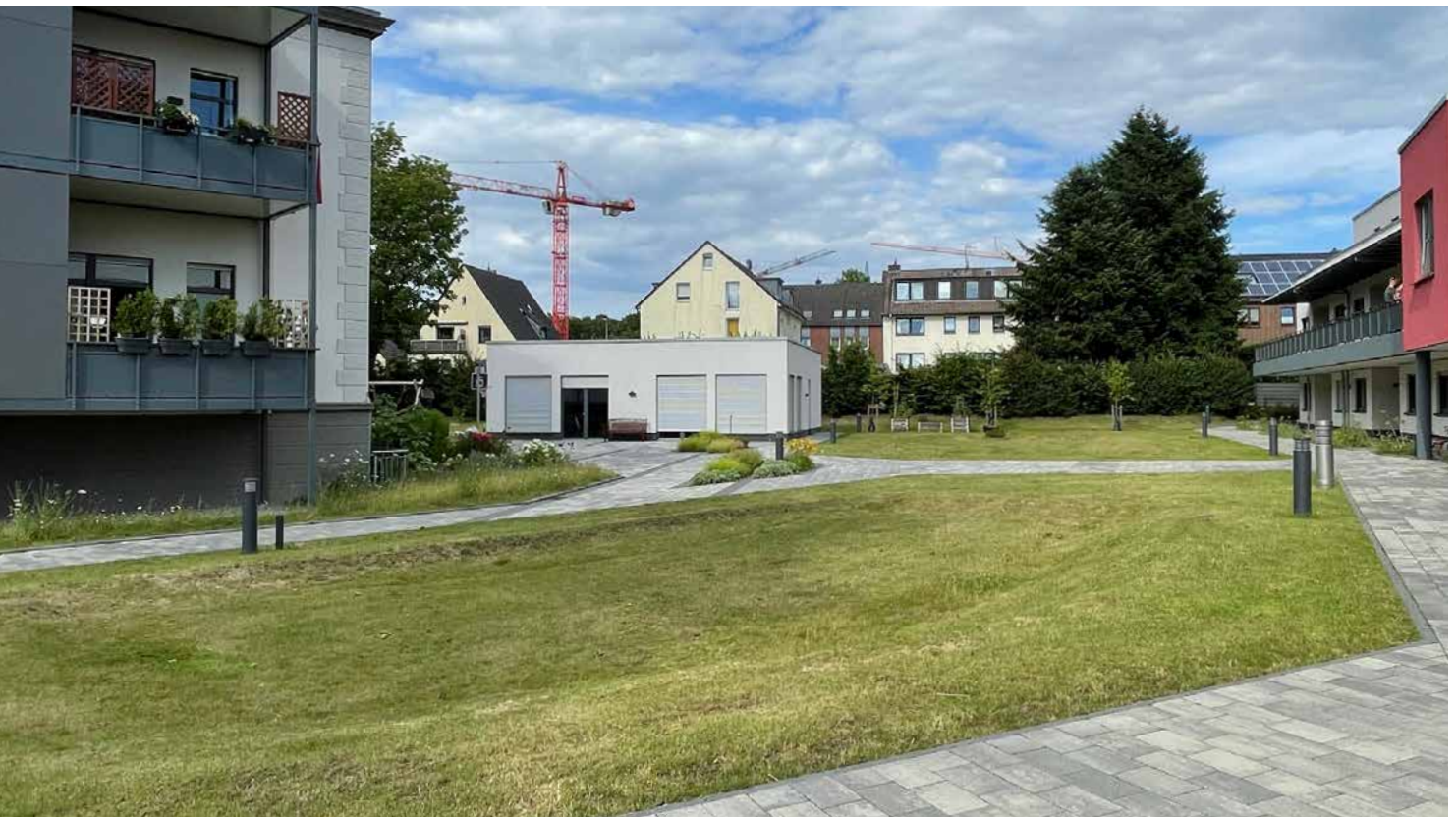
Abb. 32: Großflächige Versickerungsmulden zwischen den Gebäuden mit Blick auf den Bungalow (WINKING 2021)
