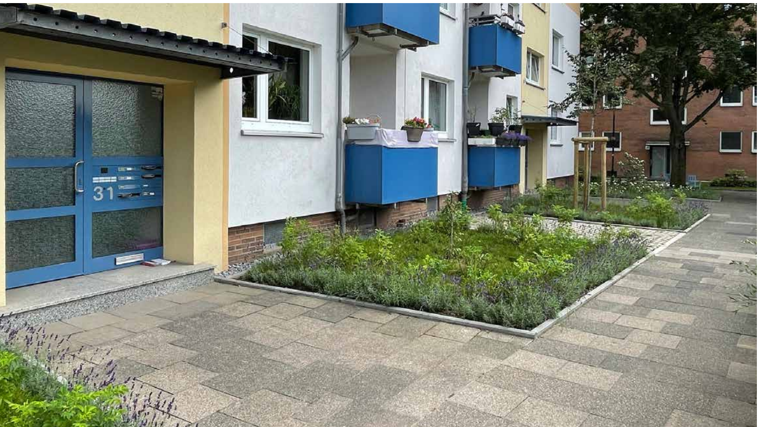
Abb. 105: Eingangsbereiche mit Anleiterflächen für die Feuerwehr Düsseldorf (WINKING 2021)
